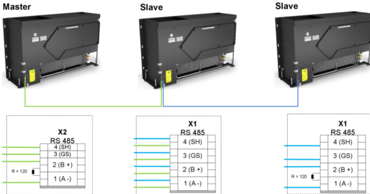
Abb. 16: FSL-CONTROL III Kommunikation 3 Geräte
