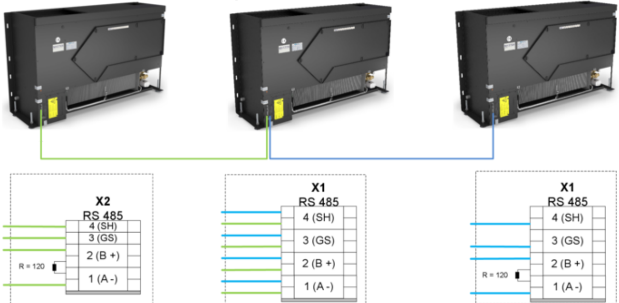
Abb. 56: FSL-CONTROL III Kommunikation 3 Geräte
