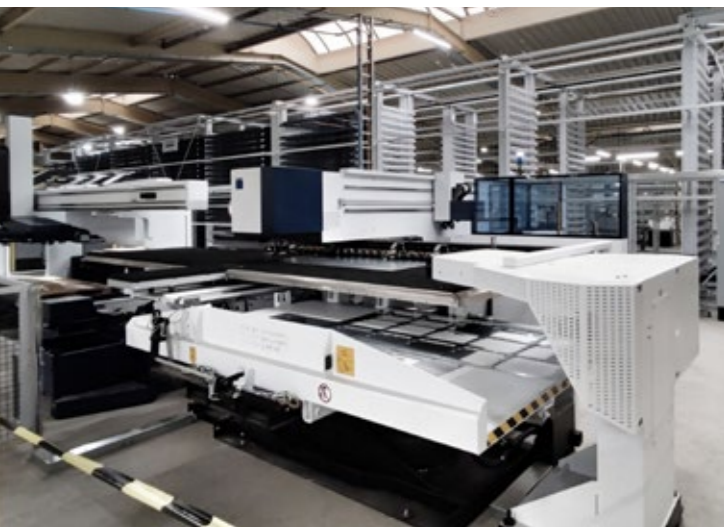
Stanz-Lasermaschine aus der Blechvorfertigung am Produktionsstandort Anholt
