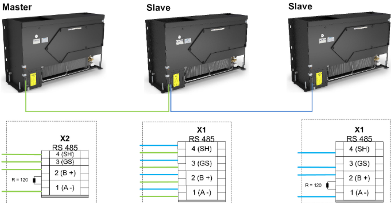
Abb. 17: FSL CONTROL III Kommunikation 3 Geräte
