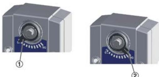
Fig. 212: Indicateur de position de lamelle
