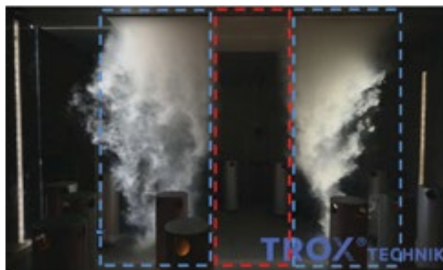
Der Aufbau des TFM-Deckenfeldes verringert die Luftdurchmischung zwischen Temperaturzonen auf ein Minimum.
