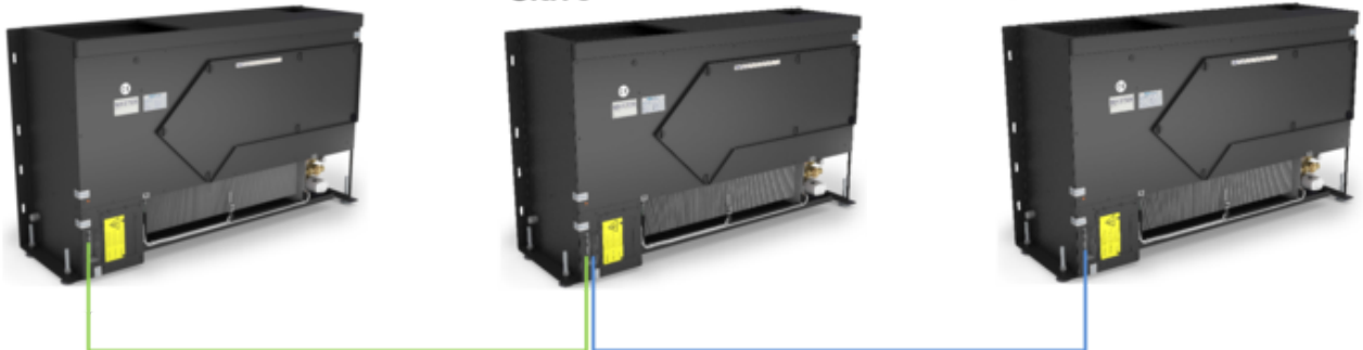
Abb. 53: FSL-CONTROL III Kommunikation 2 Geräte
