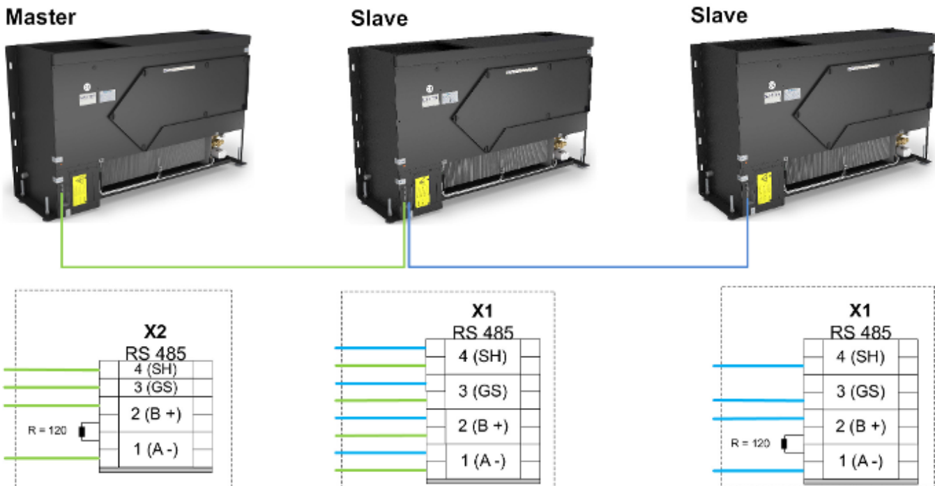
Abb. 16: FSL CONTROL III Kommunikation 3 Geräte
