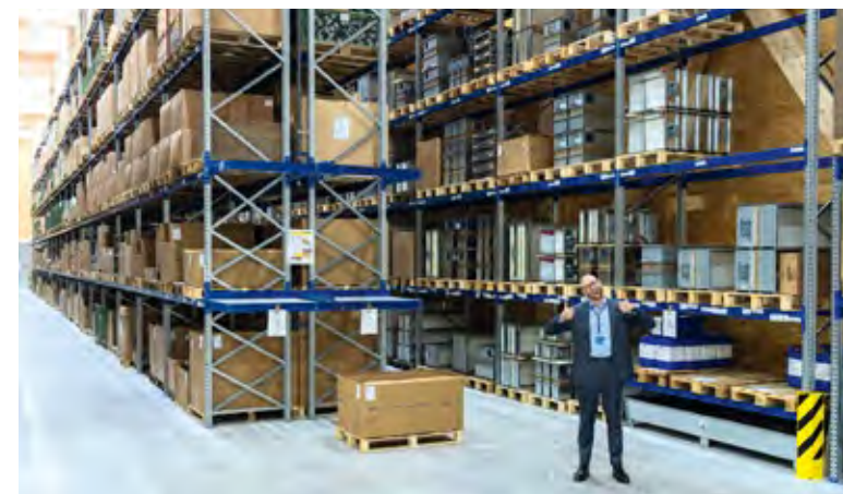
Dank induktiver Leitlinienführung können Schmalgangstapler im Schmalgang-Hochregallager bis zu 30 Palettenspiele pro Betriebsstunde realisieren.
