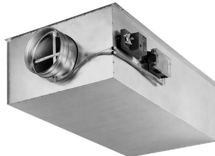
aquecimento de uma fileira, duas fileiras ou quatro fileiras ou, ainda, resistências elétricas. Os componentes de controle (controlador de velocidade, transdutor, atuador) são montados na fábrica e cabeados e conectados nos tubos de medição de pressão. As caixas VAV da TROX estão disponíveis com muitos outros componentes de controle, que são selecionados para seguir a especificação de controle. Cada caixa VAV é testada na fábrica e ajustada para as vazões de ar solicitadas.
